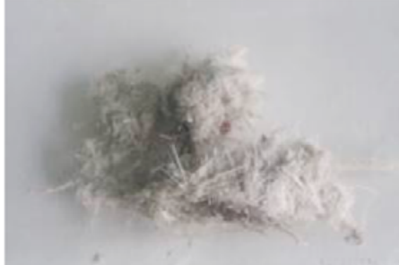
Figura N° 1: Aislación térmica de una cañería de agua caliente de una planta industrial donde se pueden evidenciar fibras de asbestos visibles a simple vista. Fotografía del autor
