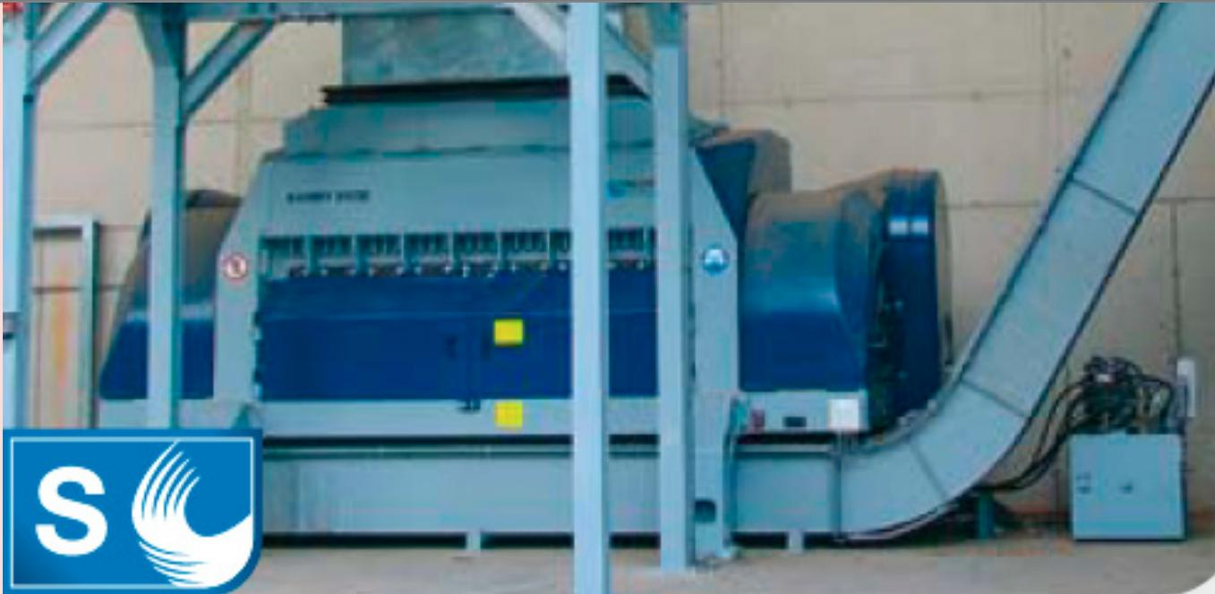
El proyecto consiste en la instalación de unas operaciones unitarias de producción y formulación de un combustible sólido derivado de residuos (CDR) para hornos de cemento, utilizando residuos industriales NO peligrosos y asimilables a urbanos, para lo cual se instalarán plantas de acondicionamiento; definirán métodos de análisis y muestreo, control de calidad, optimización de producción y análisis logístico de transporte hasta plantas de consumo.
